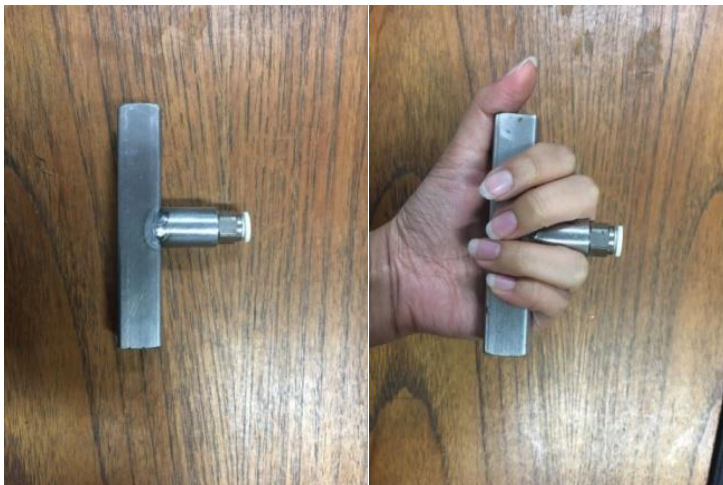
รูปที่ 9 เครื่องมือช่วยงานในการประกอบหลอดน้ำหวาน
